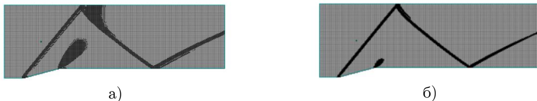
Рис. 8. Расчетная сетка при адаптации по градиенту давления а) первым и б) вторым уровнем
