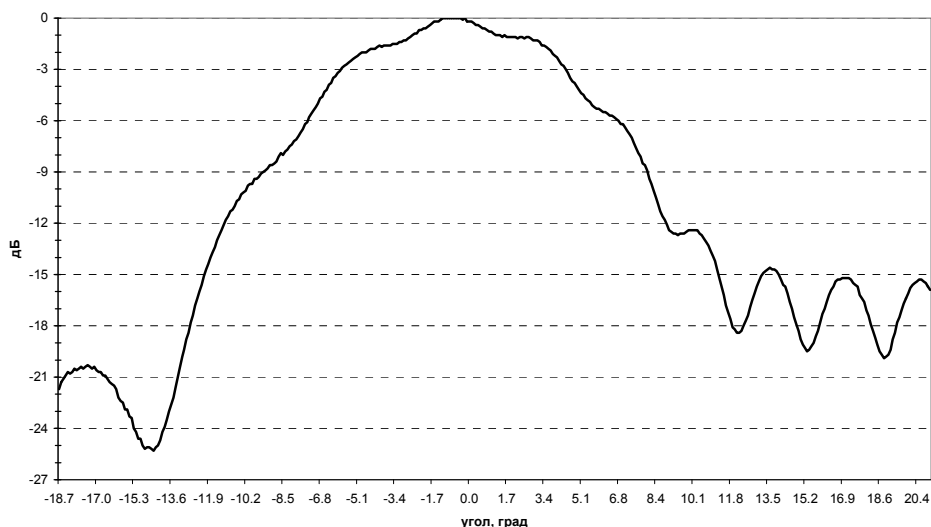
Рис. 5. Диаграмма направленности на частоте f_0 . Вертикальное сечение
