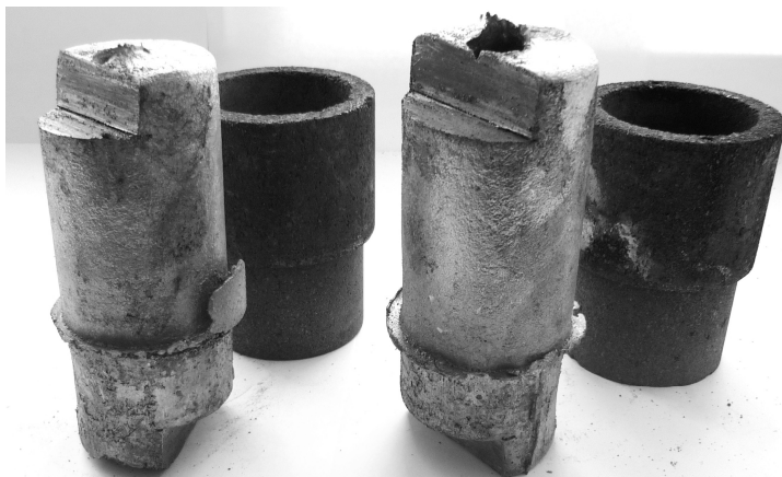
Рис. 2. Обработанный (справа) и необработанный (слева) цилиндры сплава АК7с с графитовыми трубками
