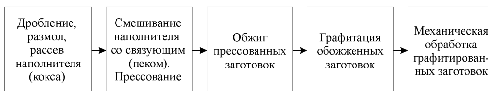
Рис. 4. Технологическая схема получения изделий на ЧЭЗ [1]
