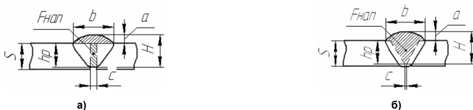
Рис. 1. Стыковое соединение для сварки под флюсом по ГОСТ 8713–79 без разделки кромок (а) и с разделкой кромок (б): a – высота шва, мм; b – ширина шва, мм; c – зазор, мм; S – толщина пластины, мм; H – высота наплавленного металла, мм; hp – глубина проплавления, мм; F нап – площадь наплавленного металла, мм 2
