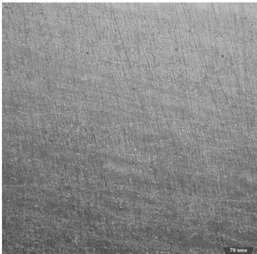
Рис. 3. Переходная зона между слоями с различным содержанием углерода, \times 150
