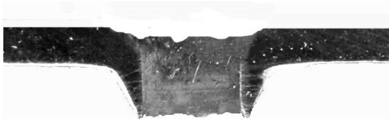
Рис. 4. Образец шлифа для измерения микротвердости в зоне деформированного металла отверстия:  $\delta = 0,88$  мм,  $d = 4,2$  мм
