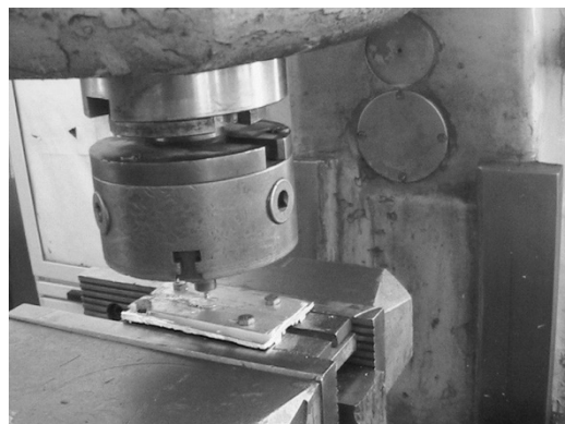
Рис. 2. Установка для сварки – вертикально-фрезерный станок СФ-15
