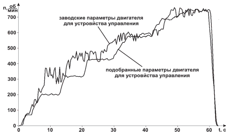
Рис. 6. Осциллограммы скорости для различных частот задания при различных параметрах асинхронного двигателя, вводимых в ПЧ со скалярным управлением
