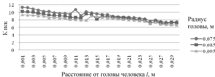
Рис. 7. Влияние размера головы на степень искажения электрического поля в зависимости от расстояния до головы человека ( l , м) при росте 172 см
