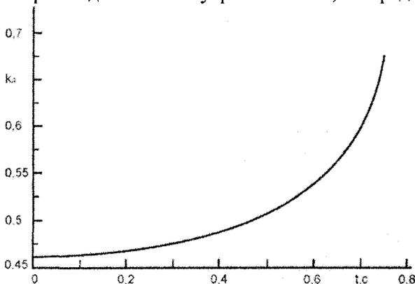
Рис. 2. Изменение коэффициента динамичности при максимально допустимом давлении и при минимальном времени заполнения внутреннего пространства цилиндрической оболочки
