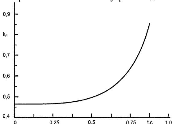
Рис. 3. Изменение коэффициента динамичности при минимально допустимом давлении и при максимальном времени заполнения внутреннего пространства цилиндрической оболочки
