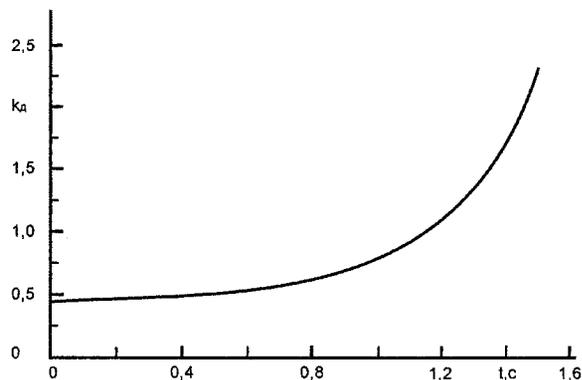
Рис. 5. Изменение коэффициента динамичности при минимально допустимом давлении и при максимальном времени заполнения внутреннего пространства цилиндрической оболочки
