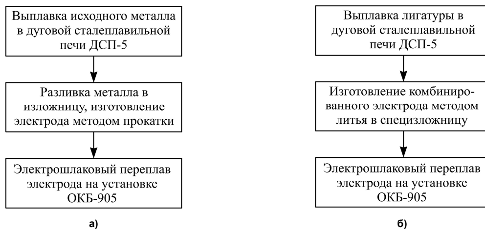
Рис. 1. Технологическая схема производства электрошлакового металла: а – классическая технология; б – предлагаемая технология
