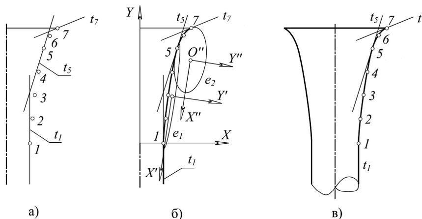
Рис. 2. Конструирование образующей диффузора: а – исходные данные; б – отсеки  $e_1, e_2$  коробовой кривой (эллипсы); в – профиль диффузора (коробовая кривая  $1...7$ )
