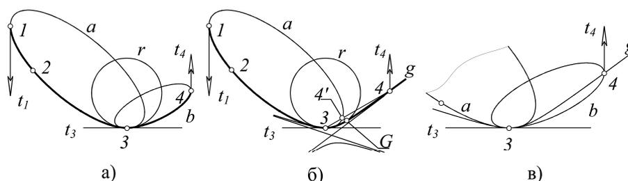
Рис. 4. Построение динамического обвода: а – обвод второго порядка гладкости; б – обвод третьего порядка гладкости; в – сравнение обводов
