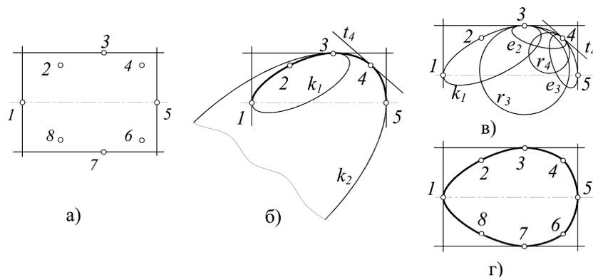
Рис. 3. Построение симметричного профиля кулачка: а – исходные данные; б – отсеки  $k_1, k_2$  коробовой кривой первого порядка гладкости; в – построение отсеков  $k_1, e_2, e_3$  коробовой кривой второго порядка гладкости; г – расчетный профиль кулачка
