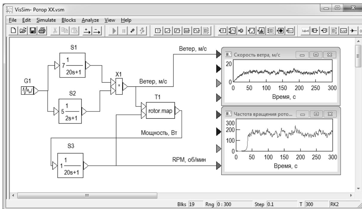
Рис. 1. Математическая модель ветра и ротора ВЭУ, работающего на холостом ходу
