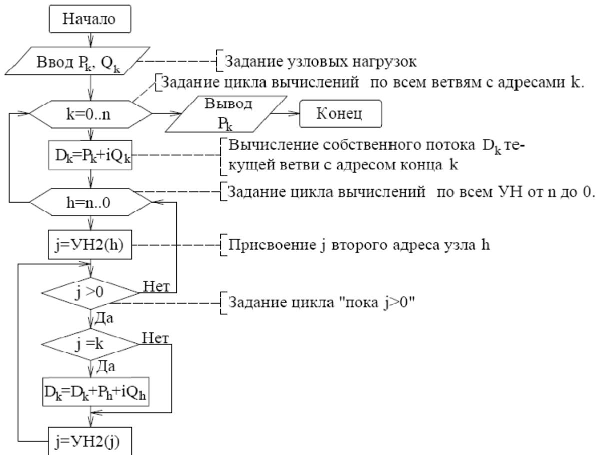
Рис. 3. Блок-схема алгоритма расчёта потокораспределения
