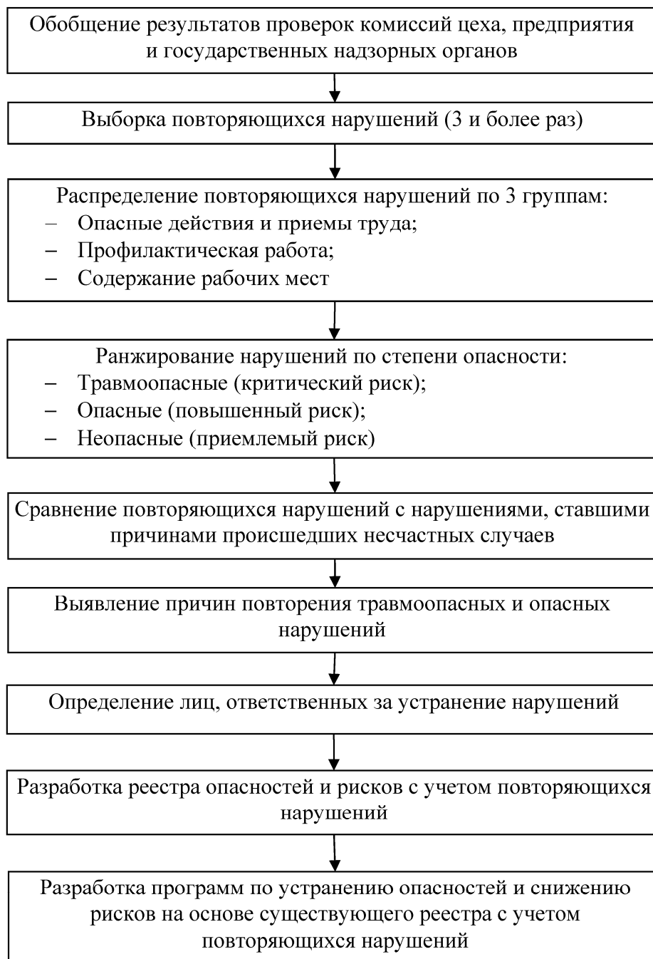
Рис. 2. Блок-схема работы по устранению повторяющихся нарушений требований ОТ и ПБ, принятая к реализации в ОАО «ВГОК»
