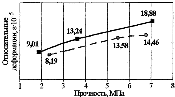
Рис. 6. Влияние добавки \text{NaNO}_2 на относительные деформации бетона, возникающие в момент первого нагружения: ■ — без добавки \text{NaNO}_2 ; ● — с добавкой \text{NaNO}_2
