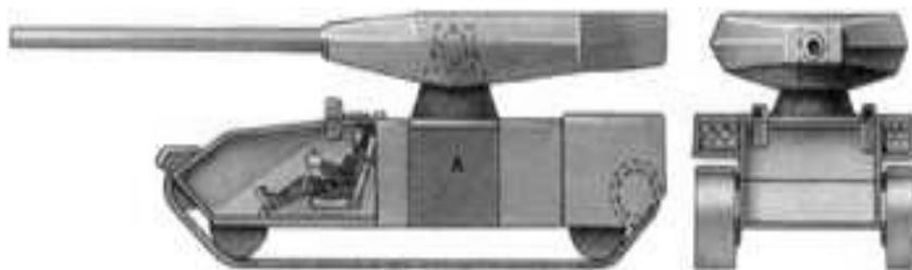
Конструктивно-компоновочная схема «полностью электрического танка» АЕТ с электромагнитной пушкой, автоматом заряжания и дистанционной системой управления стрельбой. Буквой А обозначено отделение, в котором находятся механизмы подачи снарядов и аккумуляторы
