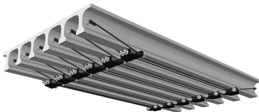
Рис. 3. Общий вид усиления балок пролетного строения моста
