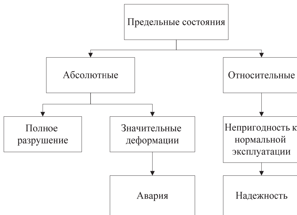
Рис. 3. Пределные состояния строительной конструкции
