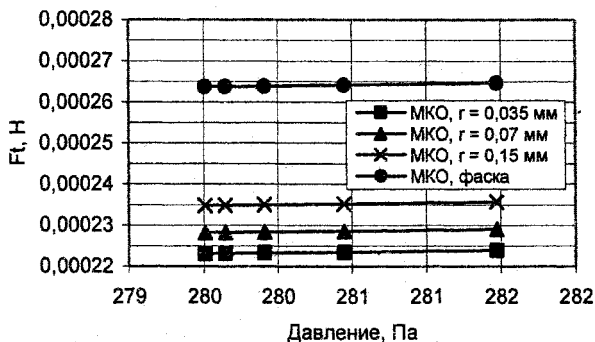
Рис. 8. Изменение касательных сил от давления при различном состоянии кромки
