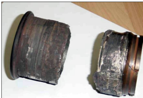
Рис. 9. Втулка пускового подшипника после разрушения. Вид 2
