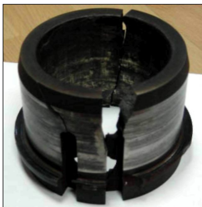
Рис. 5. Корпус пускового подшипника после разрушения. Вид 1
