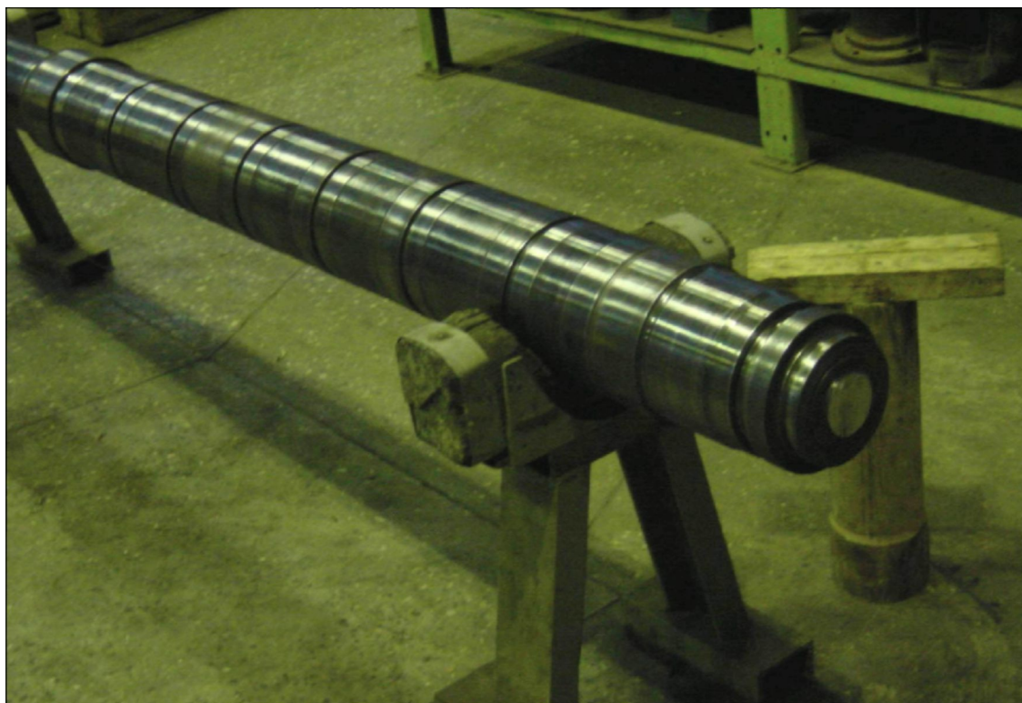
Рис. 13. Корпус уплотнения и вал с усталостной трещиной. Вид 2
