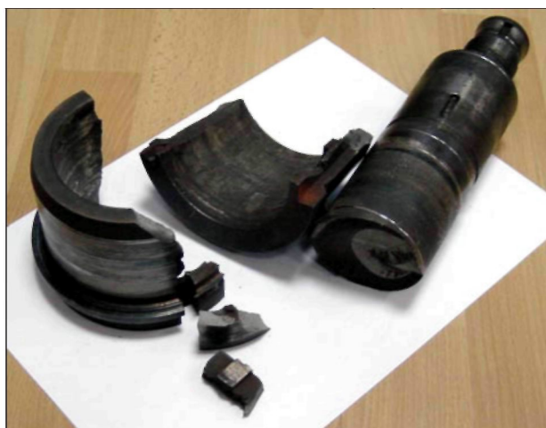
Рис. 12. Корпус уплотнения и вал с усталостной трещиной. Вид 2
