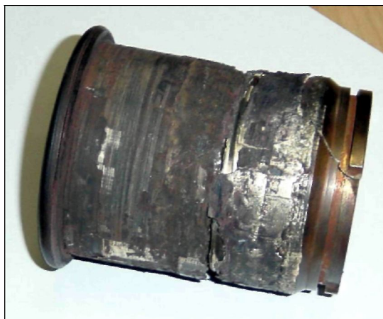
Рис. 8. Втулка пускового подшипника после разрушения. Вид 1
