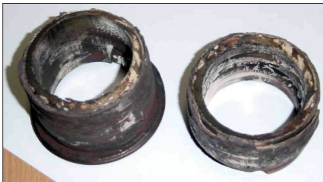
Рис. 10. Втулка пускового подшипника после разрушения. Вид 3
