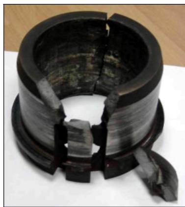
Рис. 6. Корпус пускового подшипника после разрушения. Вид 2
