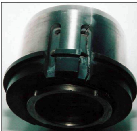
Рис. 3. Фрезерованные пазы для гидростатического подвода конденсата
