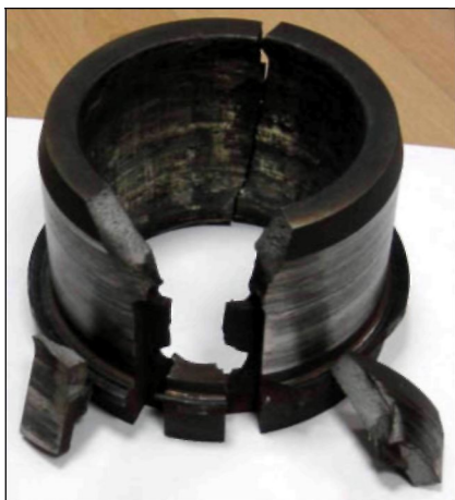
Рис. 7. Корпус пускового подшипника после разрушения. Вид 3
