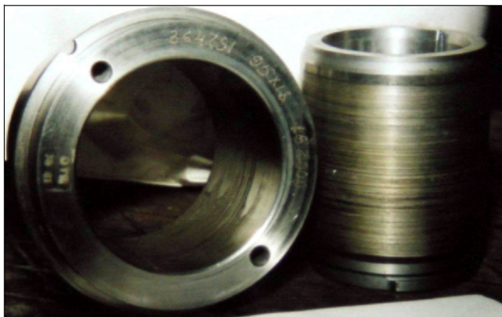
Рис. 4. Пусковой, водяной подшипник после 5000 часов работы
